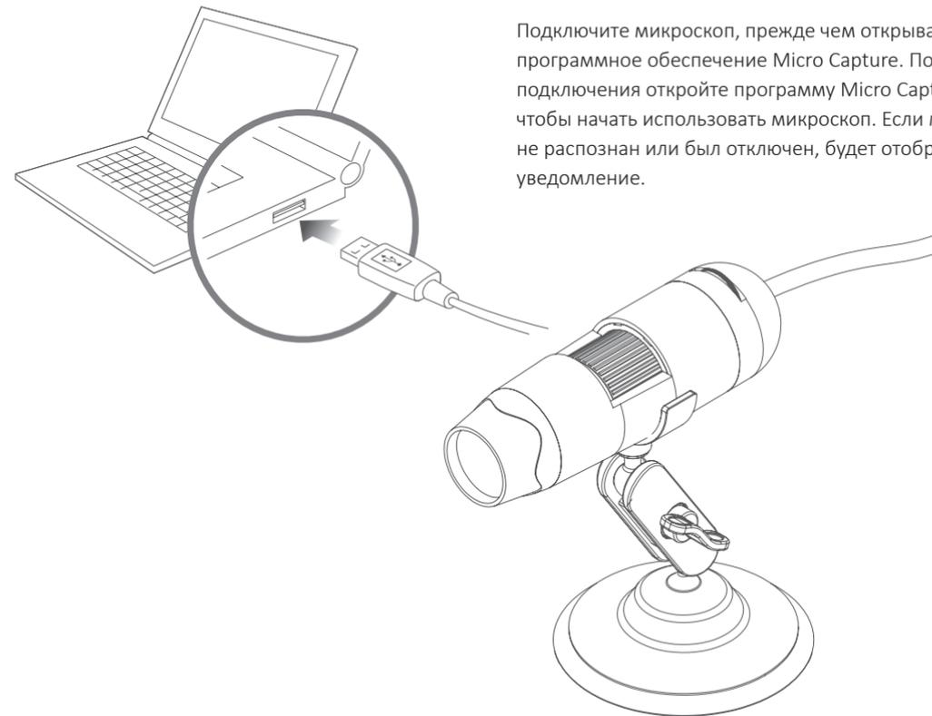
Подключите микроскоп, прежде чем открывать программное обеспечение Micro Capture. После подключения откройте программу Micro Capture, чтобы начать использовать микроскоп. Если микроскоп не распознан или был отключен, будет отображено уведомление.
