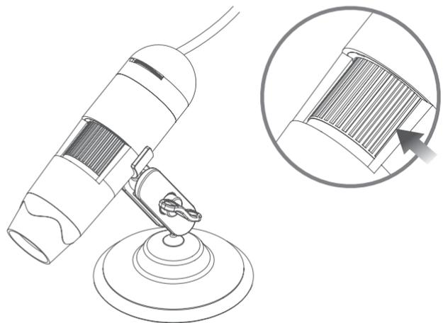
Para enfocar el microscopio, gire la rueda de enfoque en la parte frontal del microscopio; en el sentido de las agujas del reloj para acercar o en sentido contrario para alejar. Usando el software, podrá ver en pantalla si el DX-1 está enfocado.
