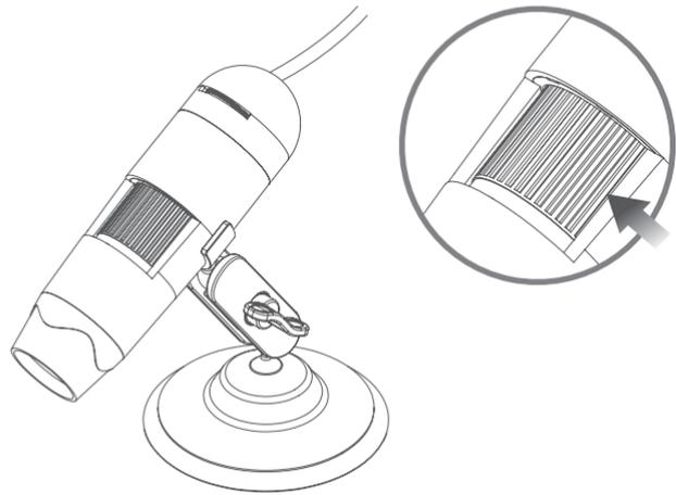
Um das Mikroskop zu fokussieren, drehen Sie das Fokussierrad an der Vorderseite des Mikroskops. zum Vergrößern im Uhrzeigersinn oder zum Verkleinern gegen den Uhrzeigersinn. Mit der Software können Sie auf dem Bildschirm sehen, ob der DX-1 scharfgestellt ist.
